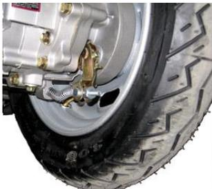
Рис. 14 Регулировка заднего тормоза и картера
